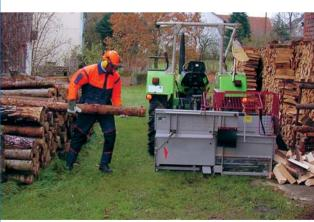
Sicher, arbeitserleichternd und zeitsparend ist der Einsatz von Säge-Spalt-Automaten. Erkundigen Sie sich bei Ihrer WBV oder FBG, wer solche Maschinen einsetzt oder verleiht.
